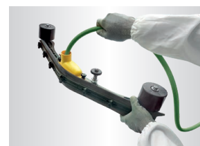
► sárga színű karbantartási alkatrészek a gép gyors és egyszerű karbantartásáért
