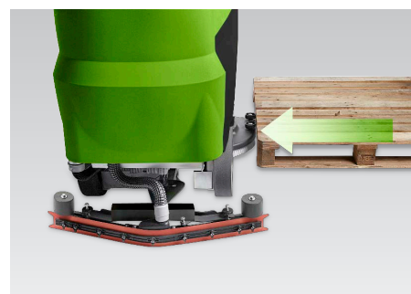
▶ ütközés esetén a tisztítókefék automatikusan visszahúzódnak
